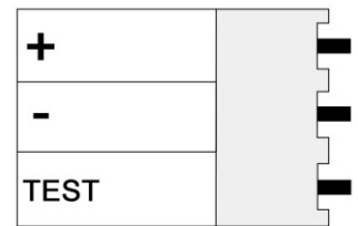
Рисунок 4. Назначение контактов разъема POWER
