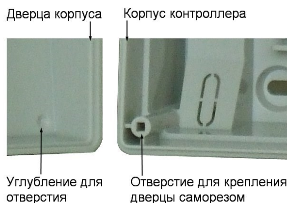
Рисунок 6. Схема «жесткого» крепления дверцы к корпусу контроллера
