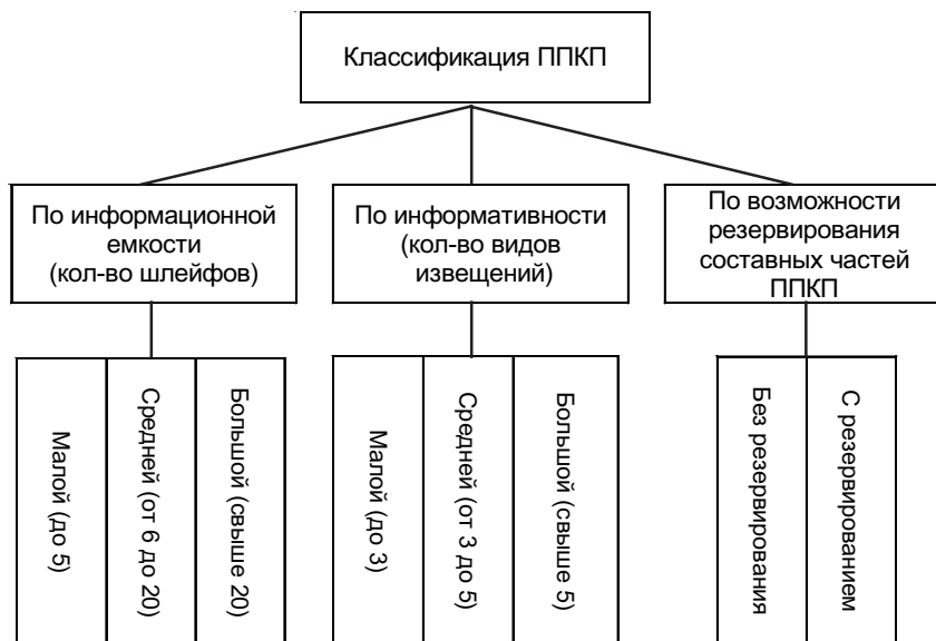
Рис. 2.3. Классификация приборов приемно-контрольных пожарных
