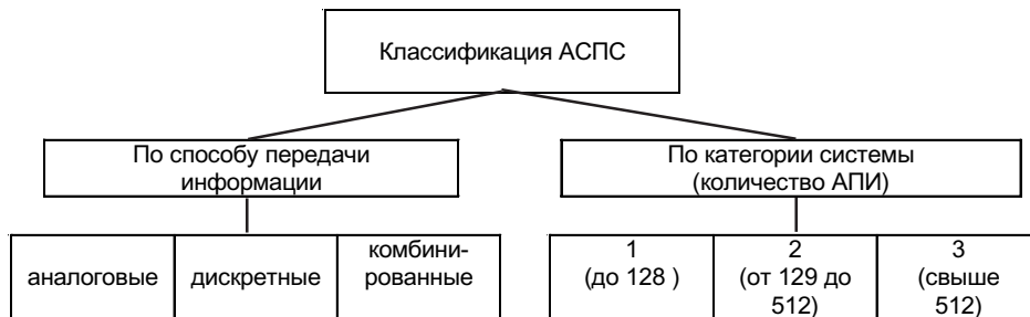
Рис. 2.2. Классификация адресных систем пожарной сигнализации
