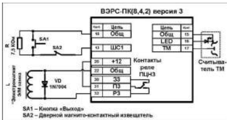
Рис.9. Схема организации Точки доступа.
