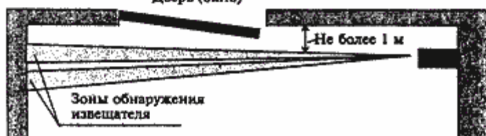
Рисунок 2 - Вариант блокировки двери (окна) на открывание и проникновение. (Размещение и схема подключения извещателей)
